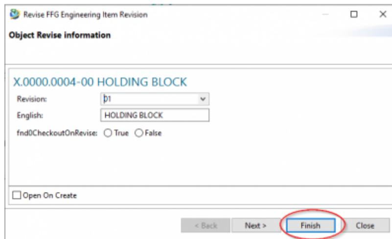
Anschließend wird unter dem Item eine zweite Revision „01“ angezeigt. Alle spezifizierenden Dokumente wie 3D-Modell (UGMASTER) oder Zeichnung (UGPART) werden als Kopie in die neue Revision übernommen.
