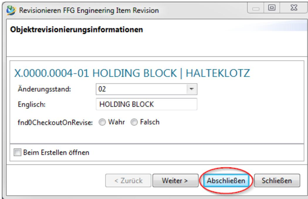
Anschließend wird unter dem Item eine zweite Revision „01“ angezeigt. Alle spezifizierenden Dokumente wie 3D-Modell (UGMASTER) oder Zeichnung (UGPART) werden als Kopie in die neue Revision übernommen.
