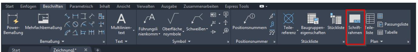
3. Nachdem Sie den Zeichnungsrahmen hinzugefügt haben, passen Sie das Layout und den Plotabstand (muss Null sein) entsprechend an.
